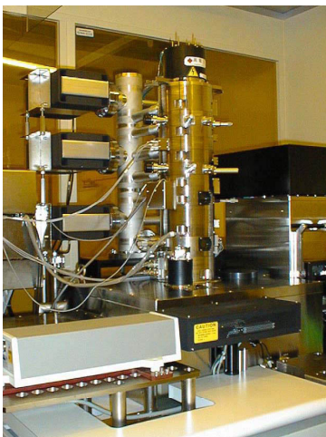
電子線描画装置 EB lithography system (Hitachi HL-700DII). 最小線幅 (Feature Size) 50nm.
