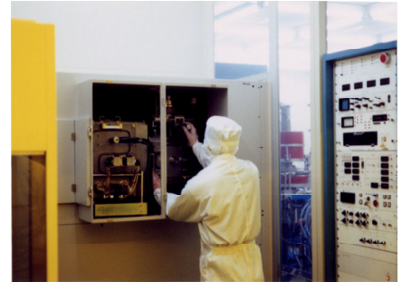
イオン注入装置 Ion implanter for doping (As, Sb, B, In, Si, Ar, He). 200 keV, 100 μA (ULVAC IM200).
