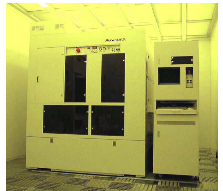
i線ステッパー i-line optical stepper (Nikon i8a).
