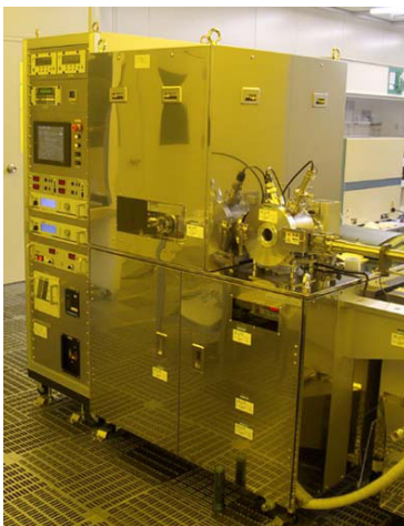
多結晶シリコン用ICPエッチャー ICP etcher for poly-Si.
