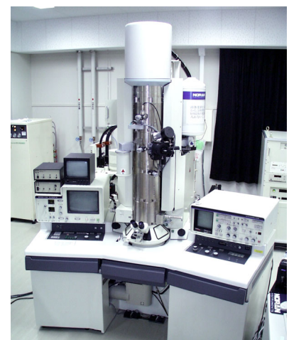
電界放出型透過電子顕微鏡 Transmission Electron Microscopy (TEM, Hitachi HF-2100) 200kV.
