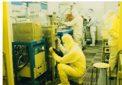
極微細パターン形成のためのドライエッチング装置 Dry etchers for ultra fine patterning.
