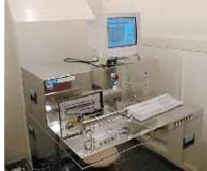
高速熱処理装置 Rapid thermal annealing system for dopant activation (Samco HT-1000) 200°C/sec.
