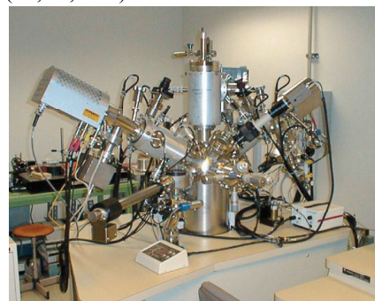
二次イオン質量分析器 Secondary Ion Mass Spectrometry (SIMS) (Phi 6500). O and Cs beams.
