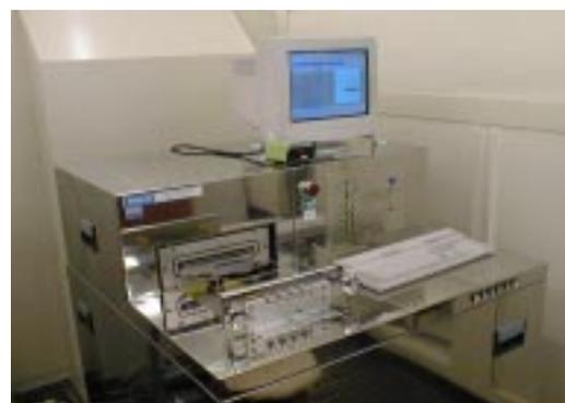
日立S-4700電界放出型走査型電子顕微鏡(FE-SEM)です。2インチウエハの全面に形成された100nm以下の微細パターンを観察し寸法を測定することができます。上記のレジストパターンはこの装置を用いて観察したものです。
