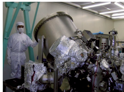
最大級(半径:300mm)の分光器を有するX線光電子分光分析装置 X-ray photoelectron spectroscopy with largest scale spectrometer (r=300mm)
